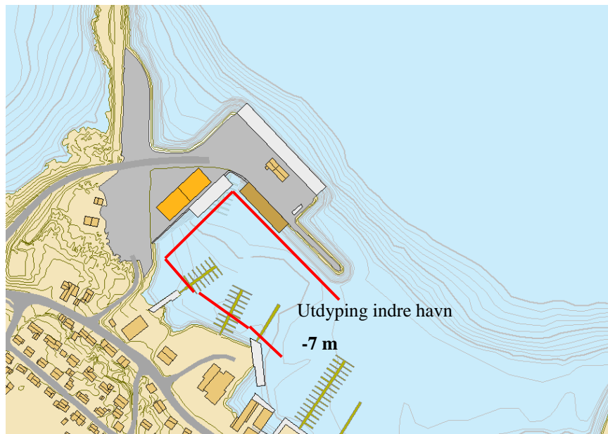
Figur 6. Forslag til en større utdyping inn mot planlagt industriområde indre havn vest, for å legge til rette for større kystfartøy. Mer detaljert skisse vil bli utarbeidet og oversendt Kystverket, basert på illustrasjon laget av Norconsult.
