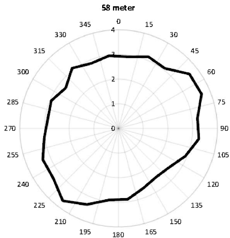
Figur 14: Gjennomsnittlig vannstrømhastighet (cm/s) for hver 15° sektor på 58 meters dyp ved Brattholmen i perioden 13.08.–13.09.2021.
